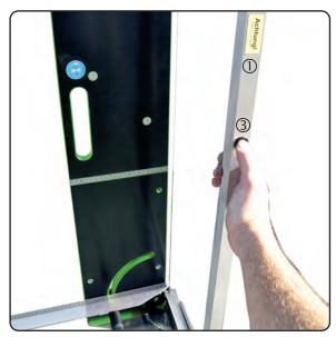
Betätigen Sie den roten Ein-/Aus-Taster ③ am Schneidebügel ① mit dem rechten Daumen um den Schneidedraht zu erhitzen. Halten Sie gleichzeitig mit der linken Hand das Schneidgut. Sie können nun durch bewegen des Schneidebügels handelsübliche Schaumpolystyrolplatten schneiden.
