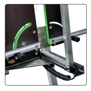
Den Hauptschneidebügel ① aus seiner Ruheposition bewegen, in die 90°-Position bringen und mit der Dreiflügelschraube oben und unten fixieren. Den Auflagewinkel ⑥ in die gewünschte Position umschwenken.
