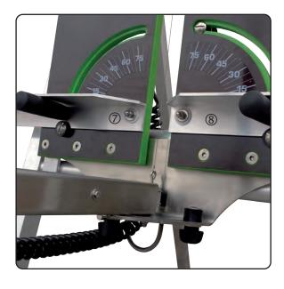
Schwenken Sie nun die Auflagewinkel ⑦ & ⑧ in die gewünschte Position und arretieren Sie sie mittels der Zylindergriffe.
