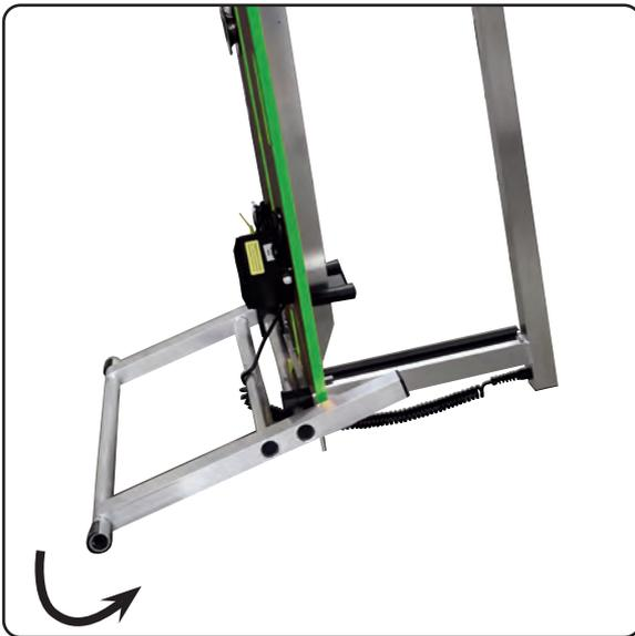
Schwenken Sie den Hauptstandfuß weiter nach vorn, während sie die Maschine anheben. Unterstützen Sie die Aufstellbewegung, indem Sie einen Fuß auf die untere Querverstrebung des Hauptstandfußes stellen.
